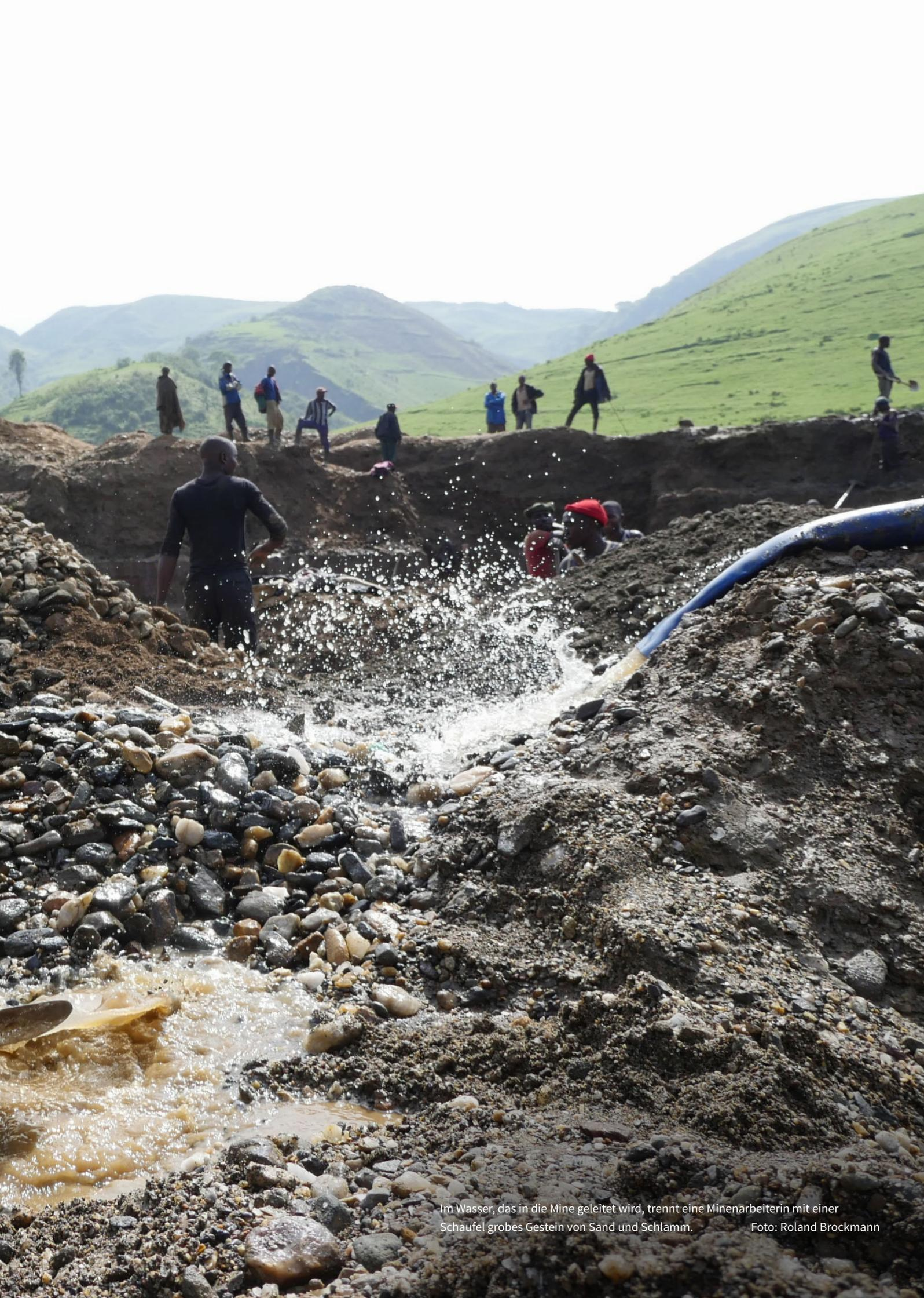
Im Wasser, das in die Mine geleitet wird, trennt eine Minenarbeiterin mit einer Schaufel grobes Gestein von Sand und Schlamm. Foto: Roland Brockmann
